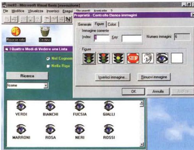
Figura 14 - MS Visual Basic 4.0 - La ListView in vista Icone e la ImageList. C'è un controllo, si chiama ImageList, che serve per creare delle collezioni di immagini, icone o Bitmap. Da sola non serve a niente. È di supporto agli altri Controlli che necessitano di Collezioni di Immagini, primo tra tutti quello che serve per creare delle Toolbar, oppure quello che serve per creare delle Liste ad Icone. Vediamo anche il nuovo Pannello che serve per inserire le proprietà di un controllo che permette una collezione di elementi.
